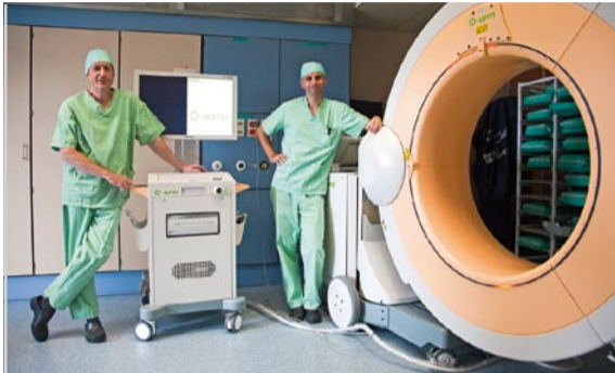
De O-vormige scanner bevindt zich tijdens de operatie rond de patiënt en maakt nauwkeurige beelden van de wervelkolom. Links dr. Frederic Martens, rechts dr. Geoffrey Lesage.
